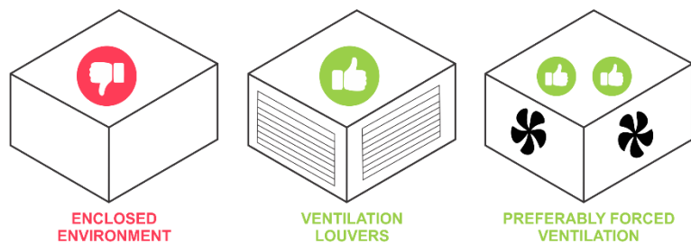
Figura 4 – Ventilação do equipamento.
