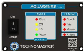
Figura 2.1 – LEDs Indicadores (SLIM 1)
