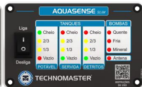
Figura 2.3 – LEDs Indicadores (SLIM 3)
