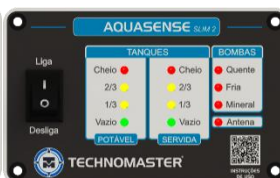
Figura 2.2 – LEDs Indicadores (SLIM 2)
