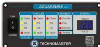
Figura 2.4 – LEDs Indicadores (SLIM 3 E VOLT)
