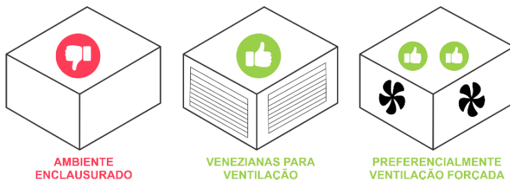
Figura 5 – Ventilação do Equipamento.
