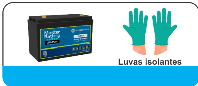
Figura 4 – Uso de luvas isolantes ao manusear a bateria.
